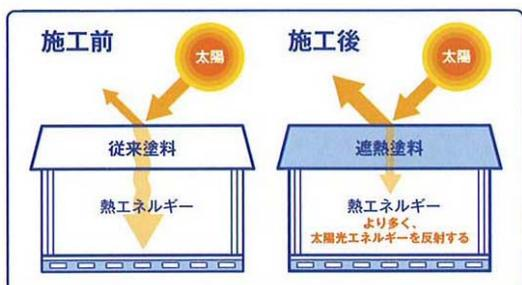
太陽の光エネルギーは、屋根に当たって熱エネルギーへと変化し、屋根の温度を上昇させます。この熱が家の中まで伝わると、室内の温度も高くなっていきます。遮熱塗料はこのメカニズムに注目し、太陽光を多く反射することで、屋根の温度上昇を最小限に抑えてくれるのです。
